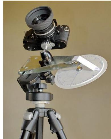
L'axe de rotation (l'axe de la charnière) doit être parallèle à l'axe de rotation de la terre. Pour ce faire, il faut que l'axe (A) vise l'étoile polaire. On doit installer l'axe à un angle, par rapport au sol, correspondant à la latitude du lieu ( $49^\circ$  pour LQB).
